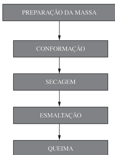
Figura 2. Fluxograma do processo produtivo de placas de revestimentos cerâmicos.
