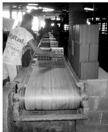
Figura 2. Operário manuseando manualmente tijolo mole.
