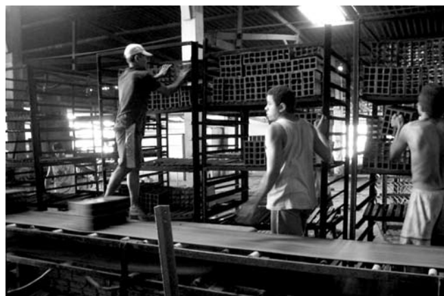
Figura 6. Sistema de armazenamento de tijolos em prateleiras incorreto.
