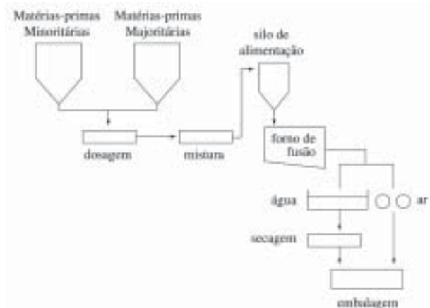
Figura 17. Diagrama do processo de fabricação de fritas.
