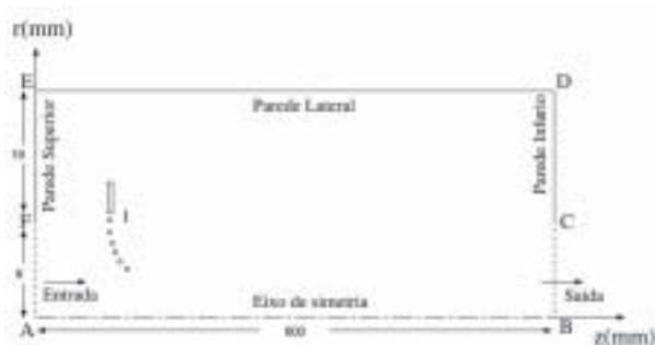
Figura 1. Domínio computacional do sistema de secagem por atomização.
