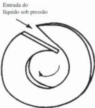
Figura 8. Representação de detalhe da espiral usada num sistema de dispersão por bico de pressão.
