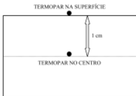
Figura 6. Ilustração do dispositivo utilizado para medir as diferenças de temperatura entre a superfície e o interior de compactos de uma massa de monoporosa.
