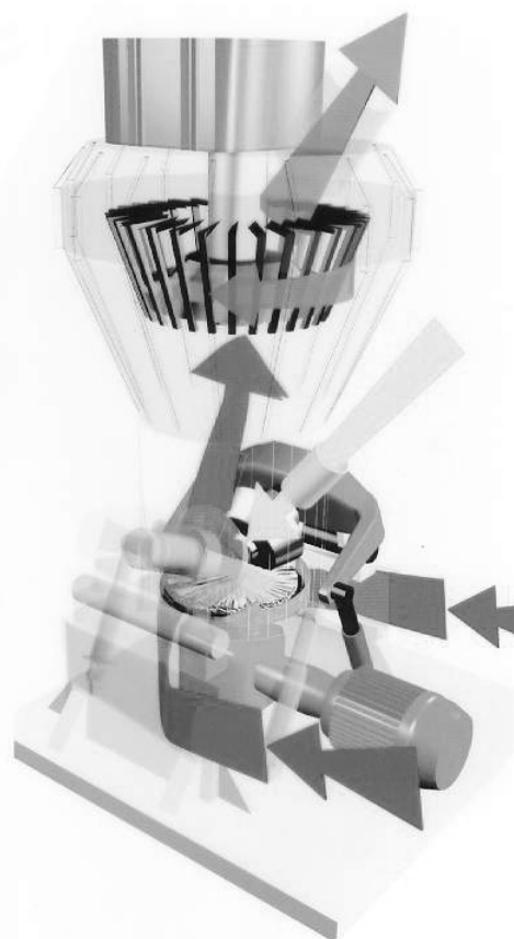
Figura 1. Esquema de funcionamento do moinho vertical a rolos.
