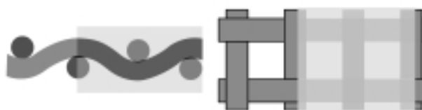
Figura 5. Vista frontal e seção transversal de uma tela sem emulsão (esquerda) e com emulsão (direita).
