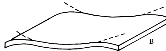
Figura 5. Peças com defeitos geométricos.
